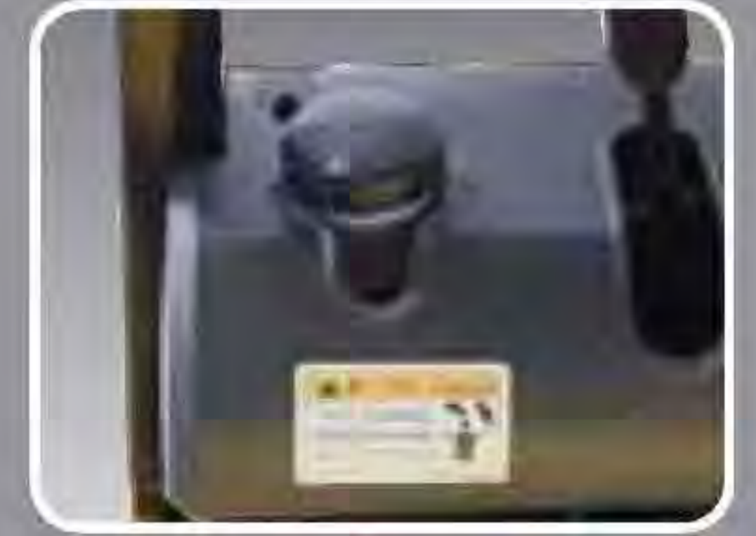
Резервуар с тормозной жидкостью
